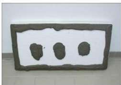
Obrázek 1: Správné nanesení lepicí hmoty na desky MW s podélným vláknem
